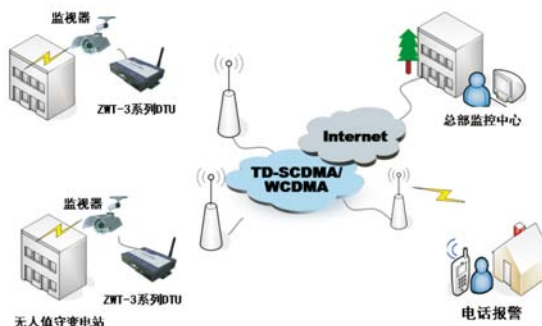
图 2 基于 3G 网络的无线监控系统
