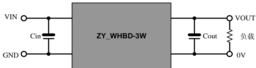
图 5.1 ZY_WHBD-3W 电源模块工作电路连接
